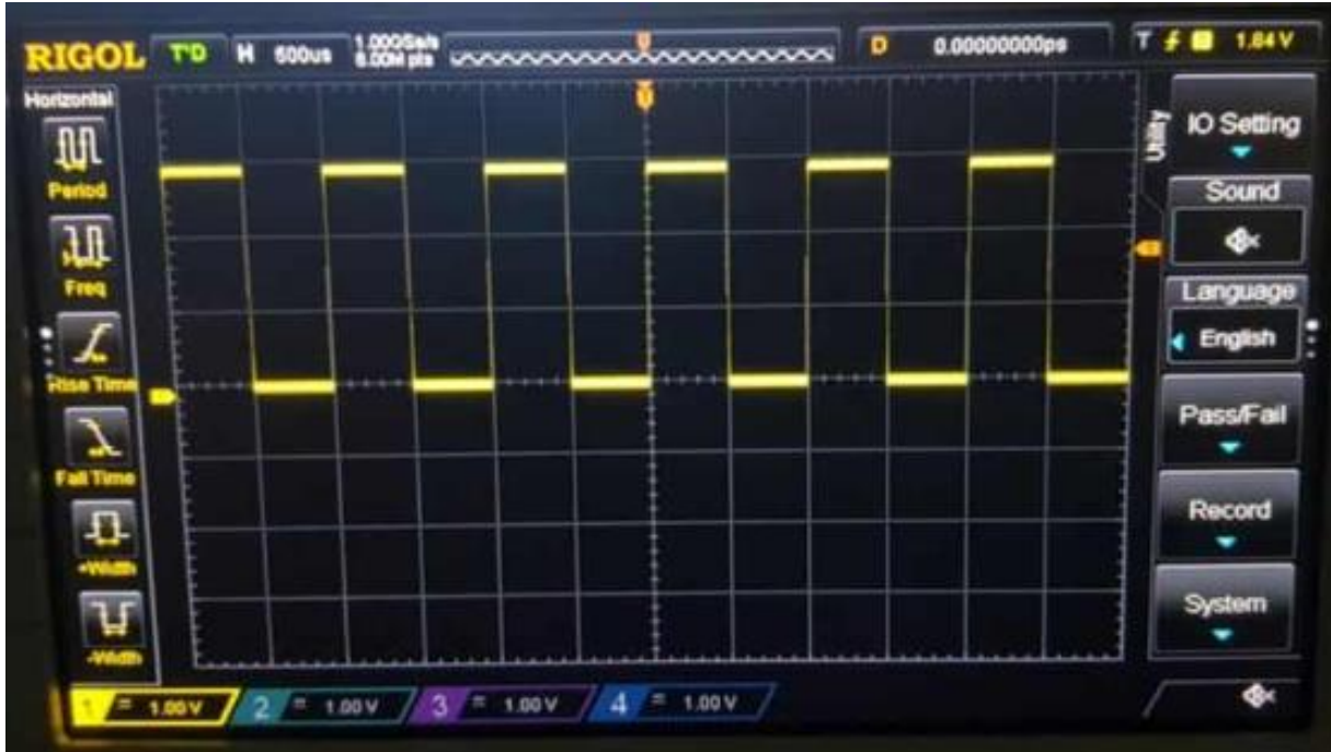
Şekil 6. Snubber Varken Mosfet Gate-Source Sinyali
