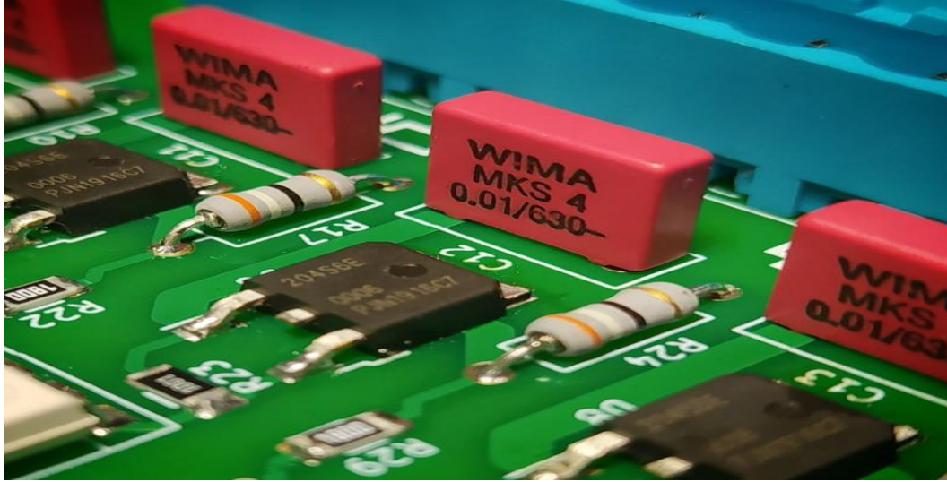
Şekil 8. PCB'de Snubber Konumlandırılması - 1
